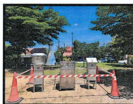
ภาพที่ 4.4.1-1 การเก็บตัวอย่างฝุ่นละอองในบรรยากาศโดยทั่วไป
