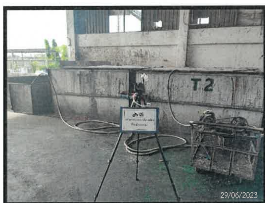
ภาพที่ 4.2.5-1 การเก็บตัวอย่างการตรวจวัดฝุ่นละอองทุกขนาด (Total Dust)
