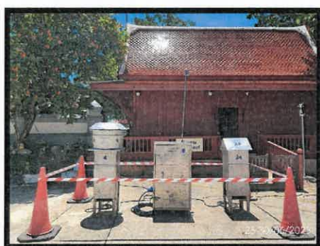
ภาพที่ 4.4.1-1 การเก็บตัวอย่างฝุ่นละอองในบรรยากาศโดยทั่วไป
