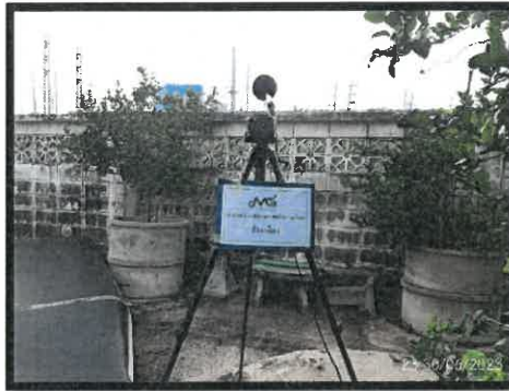
ภาพที่ 4.4.3-2 การตรวจวัดระดับเสียงโดยทั่วไปในบรรยากาศ ( L_{eq} 24 hr. , L_{max} , L_{dn} , L_{90} และเสียงรบกวน)
